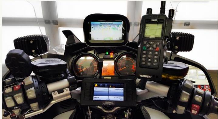
*Cockpit der BMW R 1200 RT: Telemetrie mit Navigationsgerät, HRT-Digitalfunk, Bordcomputer und Bedienelemente für Sonderwarneinrichtung u.a.*
